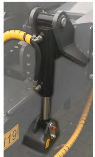
Serienausrüstung: hydraulische Steuerung der Funktionen, Druckluftbremsanlage, Elektrik gem. StVZO, Abstellbremse, Kotflügel, Unterlegkeile, seitlicher Unterfahrschutz, hydr. Stützfuß, Containerverriegelung, hydr. Achsenabstützung
