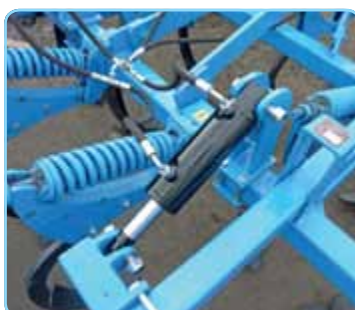
Hydraulic ajustement of working depth / die hydraulische einstellung der Arbeitstiefe / Reglage hydraulique de la profondeur de travail
