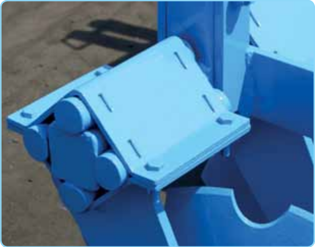
shock absorber / die Gummisicherung / protection par amortisseur en caoutchouc
