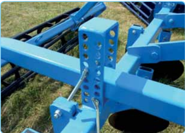
working depth adjustment on the frame / die Einstellung der Arbeitstiefe mittels Lochleisten / réglage de la profondeur de travail
