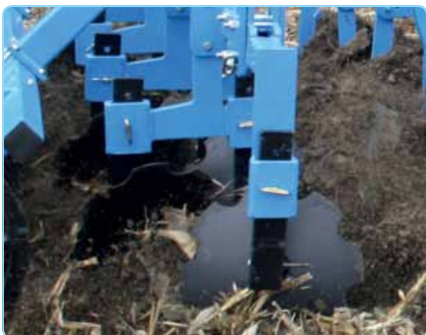
notched discs 465 mm / die gezackten Scheiben 465 mm / disques crenelées 465 mm
