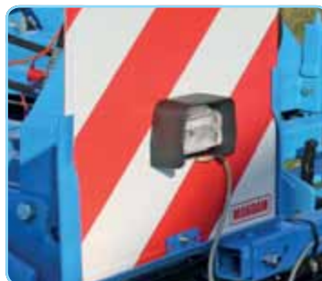
Transport lights / Beleuchtungsalnge mit Warntafel / Eclairage de route
