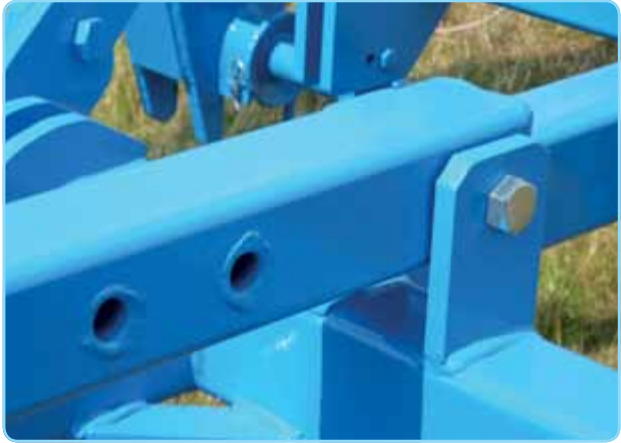
adjustment of the roller offset / die Einstellung des Walzenabstandes hinter der Maschine / réglage de décalage de rouleau
