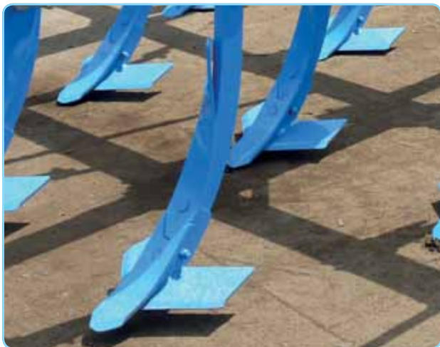
working tools on high tine / Flügelschare mit hohen Leitblechen / soc avec un haut versoir
