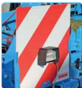
Transport lights / Beleuchtungsanlage mit Warntafel / Eclairage de route
