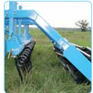
Tines before roller / Striegelbalken von der Walze / Herse à peigne avant le rouleau
