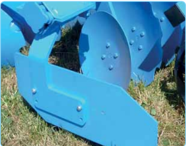
side plate mounted on shock absorbers / die Randleche auf Gummi befestigt / plaques laterales a ressort
