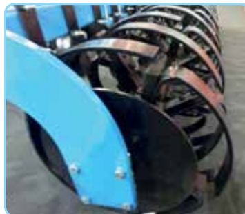
Springroller \varnothing 420 mm / Flexringwalze \varnothing 420 mm / Rouleaux S-ring \varnothing 420 mm
