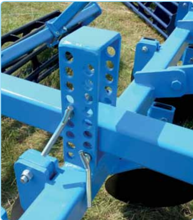
working depth ajustement on the frame / die Einstellung der Arbeitstiefe mittels Lochleisten / réglage de la profondeur de travail
