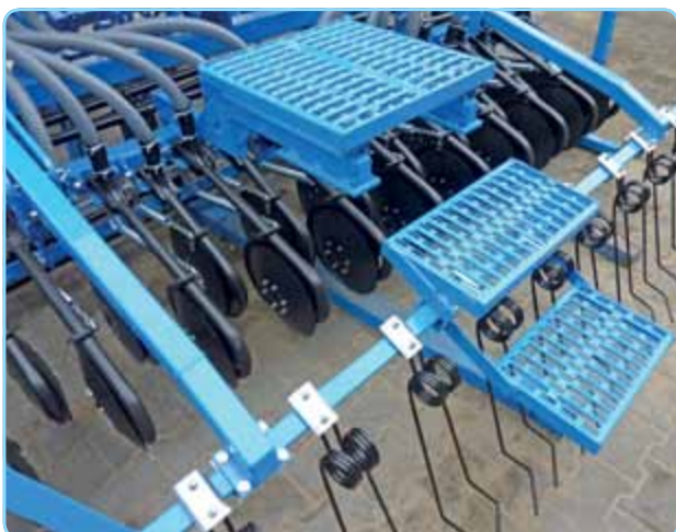
platform and tines / Bediensteg und Striegelbalken / herse niveleuse et rampe d'accès
