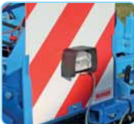
Transport lights / Beleuchtungsalnge mit Warntafel / Eclairage de route
