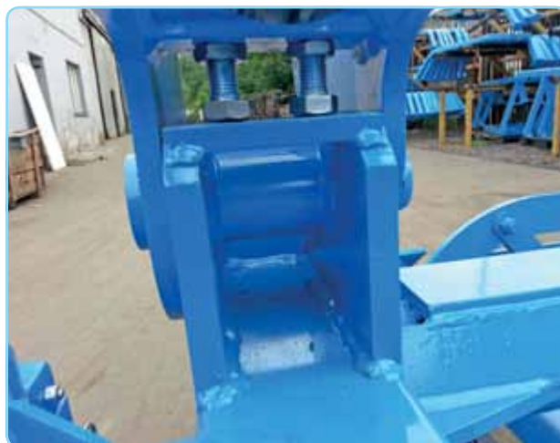
side wings adjustment / die Einstellung der Rahmenhöhe / réglage de niveau des ailes
