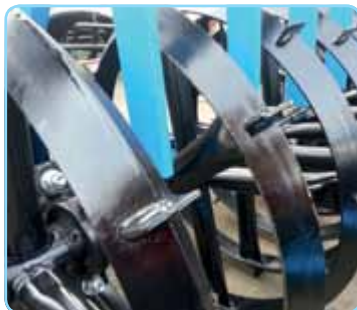
Ringroller (V-ring) \varnothing 600 mm with paddle / Dachringwalze (V-ring) mit Mitnehmern \varnothing 600 mm / Rouleau a V-ring la dent \varnothing 600 mm
