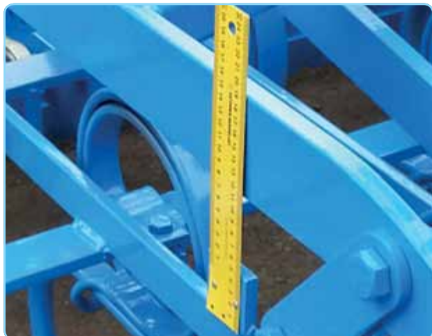
working depth measure / das Lineal die Arbeitstiefe anzeigt / mesure de profondeur de travail
