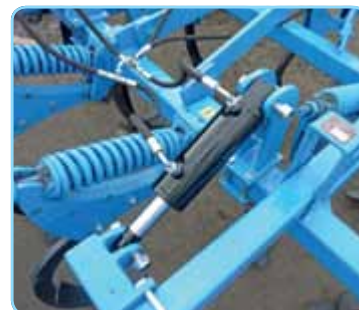
Hydraulic adjustment of working depth / die hydraulische einstellung der Arbeitstiefe / Reglage hydraulique de la profondeur de travail
