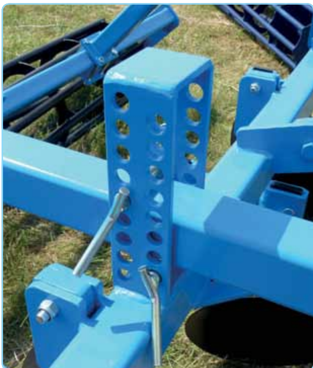
working depth adjustment on the frame / die Einstellung der Arbeitstiefe mittels Lochleisten / réglage de la profondeur de travail
