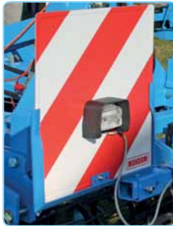
Transport lights / Die Beleuchtungsanlage / Éclairage de route
