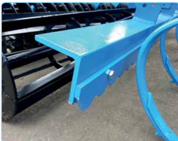
drag leveller / die Einebnungsschiene / planche niveleuse
