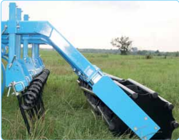
Tines before roller / Striegelbalken von der Walze / Herse à peigne avant le rouleau
