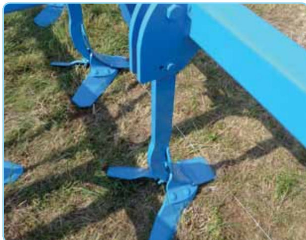
bolt protection / Bolzensicherung / sécurité a boulons
