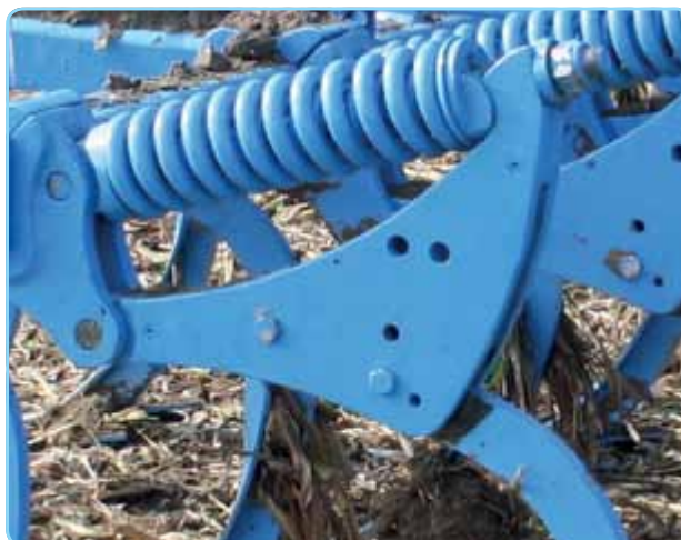
doublespring protection / die Federsicherung / sécurité a ressorts
