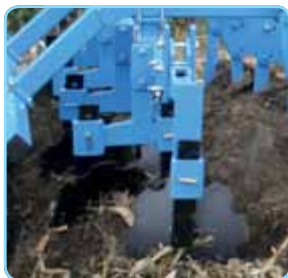
Beam with discs on roller arms / Hohl-scheiben am Walzenholm / Disques attelées sur les bras de rouleau
