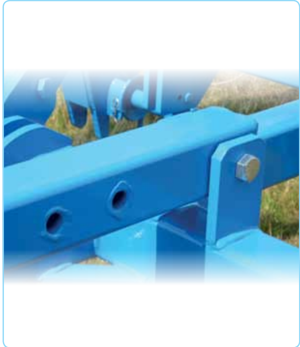
adjustement of the roller offset /die Einstellung des Walzenabstandes hinter der Maschine / réglage de décalage de rouleau
