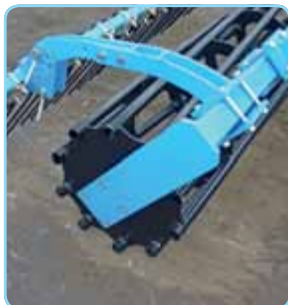
Tines after roller / Striegelbalken hinter der Walze / Herse à peigne derrière le rouleau
