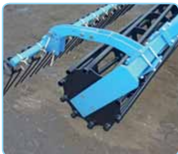
Tines after roller / Striegelbalken hinter der Walze / Herse à peigne derrière le rouleau
