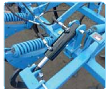
Hydraulic adjustment of working depth / hydraulische Einstellung der Arbeitstiefe / Reglage hydraulique de la profondeur de travail
