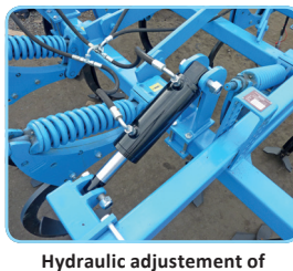
Hydraulic adjustment of working depth / die hydraulische einstellung der Arbeitstiefe / Reglage hydraulique de la profondeur de travail
